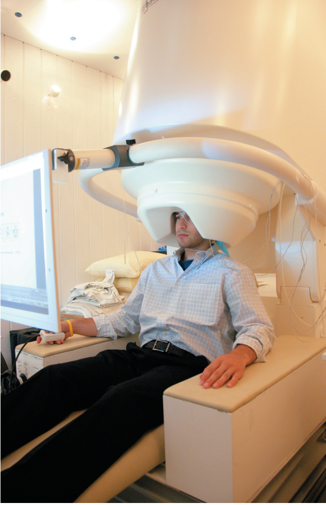
▲ Foto 8: Beyin fonksiyonlarının SQUID ile ölçülmesi.
